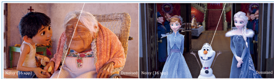
图4 基于深度学习的蒙特卡洛重建方法通过训练神经网络以预测重建滤波核,可在数秒钟内重建光滑图像 [24]
